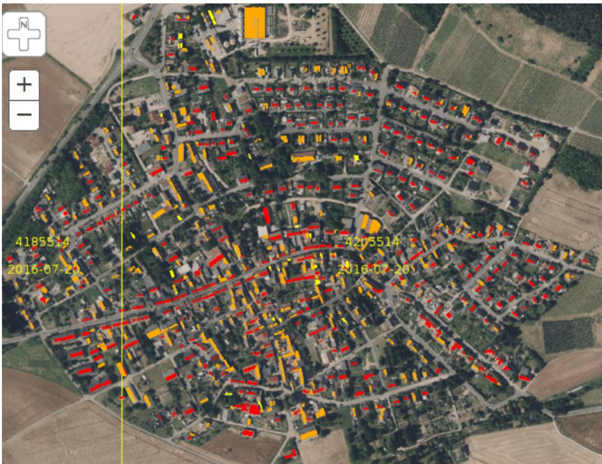
Abb. 4-10: Eignung Photovoltaik OG Fürfeld (Kreisverwaltung Bad Kreuznach, 2018)
